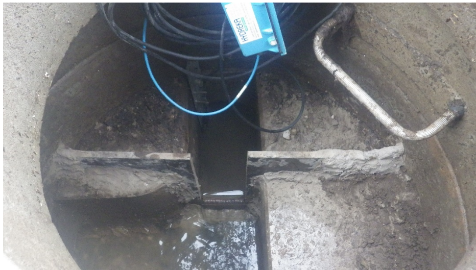
Figure 17 : Regard M3 équipé en nappe haute
