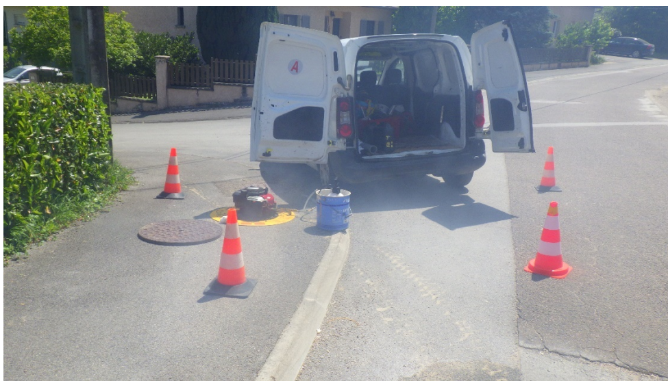
Figure 82 : Générateur de fumée en fonctionnement
