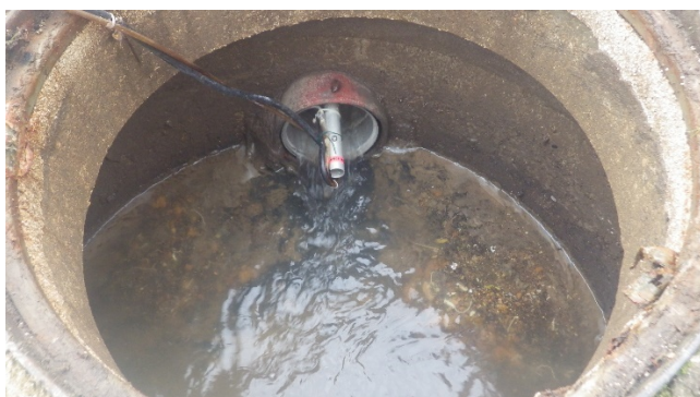
Figure 29 : Regard M6 équipé en nappe haute
