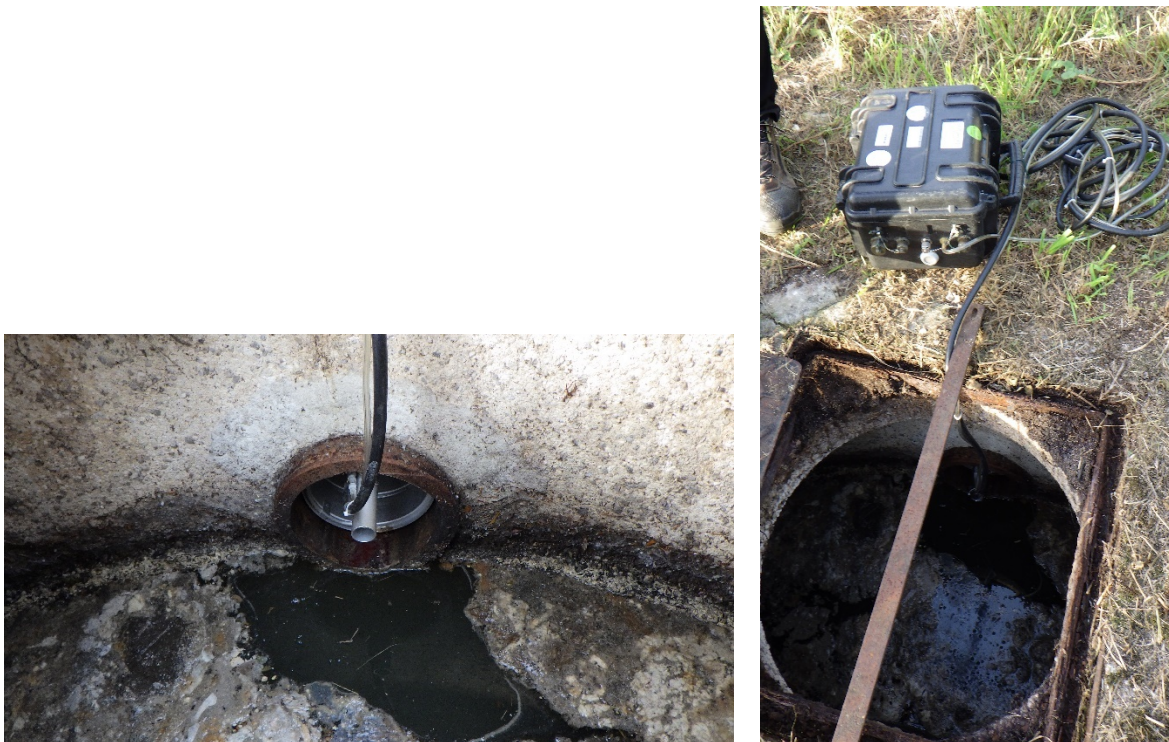
Figure 9 : Point M1 équipé en nappe basse
