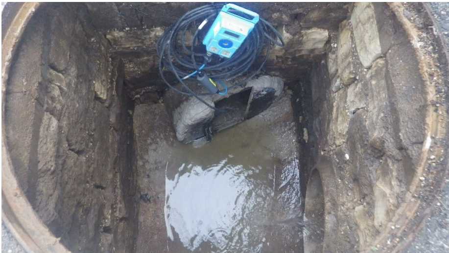
Figure 37 : Regard M8 équipé en nappe haute et nappe basse
